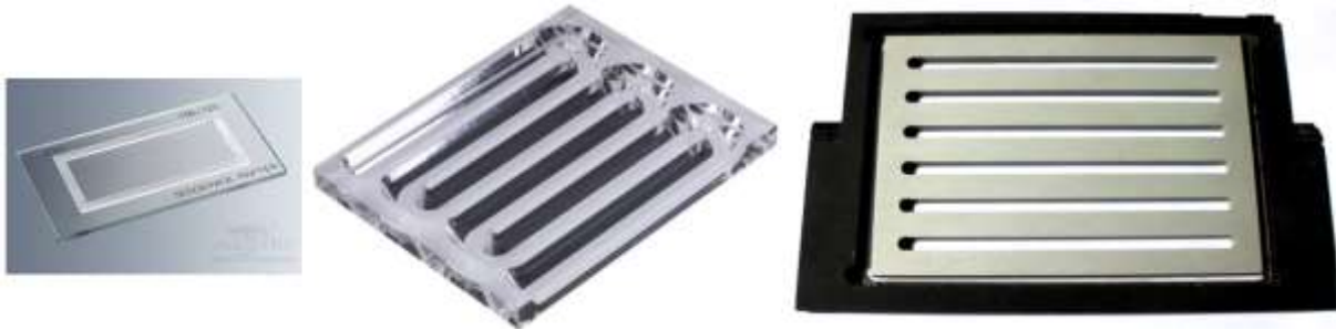
Figura 3 Tipos de cámara de conteo: Sedgewick Rafter (izquierdo) y Bogorov (centro, derecho)
